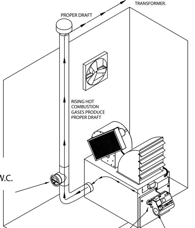
SERVICEMAN ADJUST BAROMETRIC DAMPER TO OBTAIN  $-.04$  TO  $-.06$  W.C. DRAFT AT STACK
